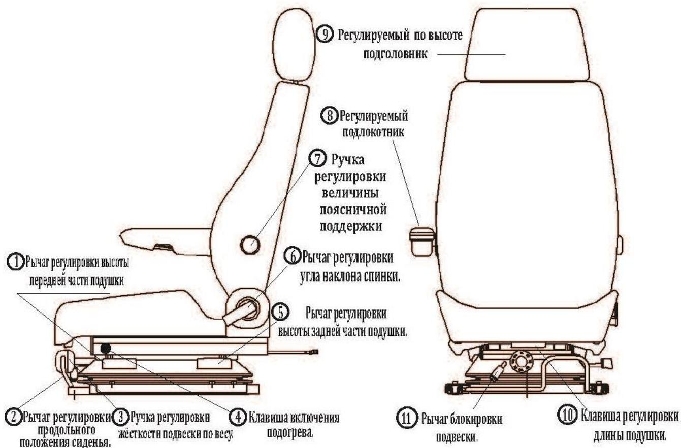
1. При поднятии рычага передняя часть расфиксируется и может фиксироваться по высоте в разных положениях с шагом 6 мм. Диапазон перемещения 60 мм.
