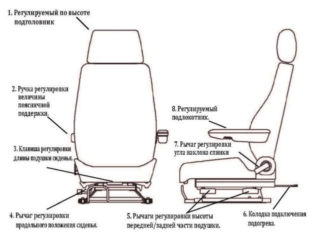
Для выбора высоты подголовник 1 имеет 4 фиксированных положения с шагом 20 мм, перемещается при воздействии на него вдоль направляющих. Снятие подголовника требует приложения увеличенных усилий.
