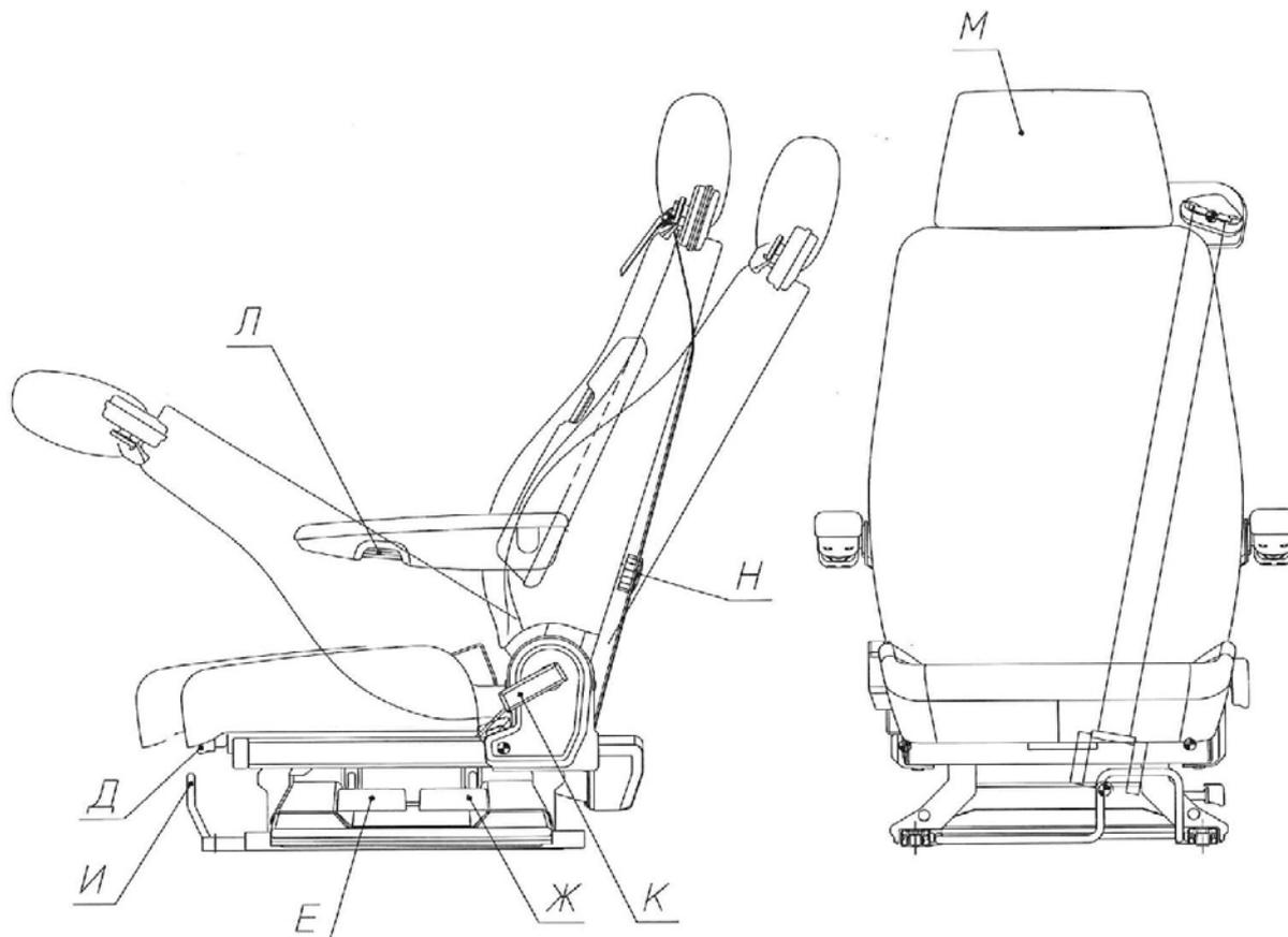
Для выбора высоты подголовник М имеет 4 фиксированных положения с шагом 20 мм, перемещается при воздействии на него вдоль направляющих. Снятие подголовника требует приложения увеличенных усилий.
